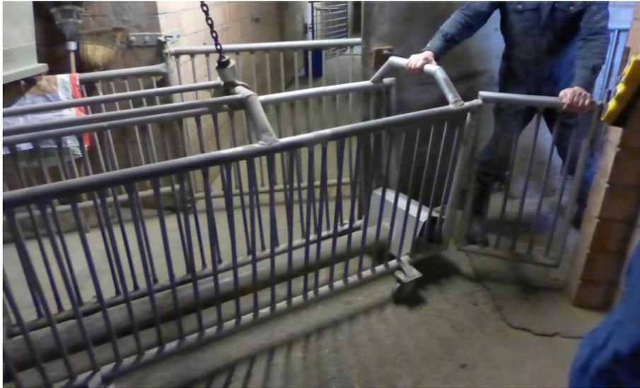
Eine besonders gute Lösung eines selbstgebauten Klauenpflegestandes. Zusätzlich zum genau angepassten Maß und dem Aufreitrohr in der Mitte (Bauch der Sau) wurde auch eine „Sitzfläche“ für die Sau (rechts) eingeschweißt
