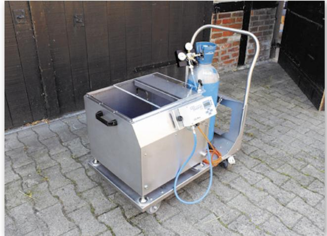
Abbildung 14: CO<sub>2</sub>-Betäubungsgerät für Ferkel ≤ 5 kg
